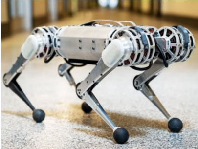
图4 具备刚性腰部的四足机器人
